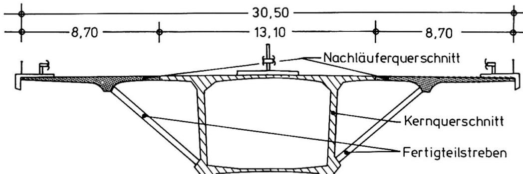
Abb. 2 Brückenquerschnitt
