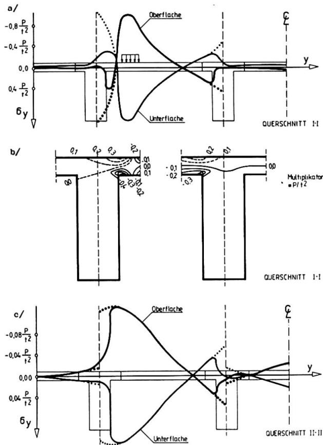
Bild 3. Normalspannungen  $\sigma_y$  in Fahrbahnplatte und Trägerstegen.
