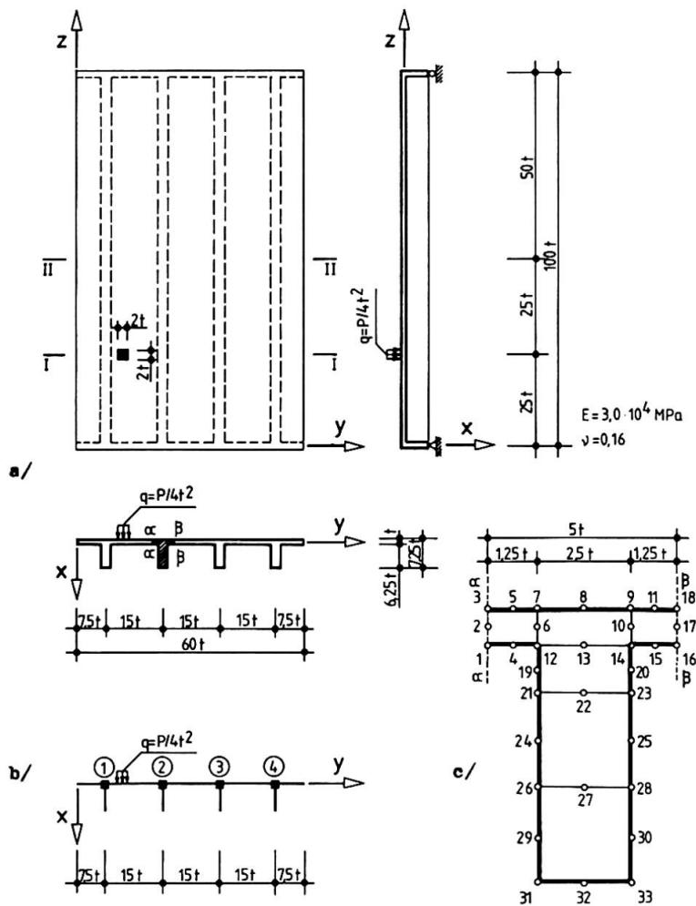
Bild 1. Konstruktionbezeichnung und Aufteilung der Konstruktion in Elemente.
