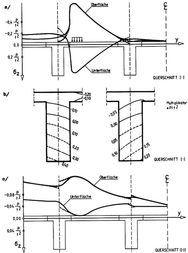
Bild 2. Normalspannungen  $\sigma_z$  in Fahrbahnplatte und Trägerstegen.
