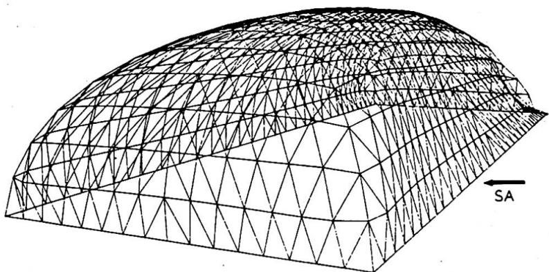
Bild 4: Traglufthalle unter Windlast
