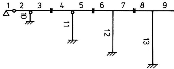
Abb. 3 Statisches System für die elektronische Berechnung
