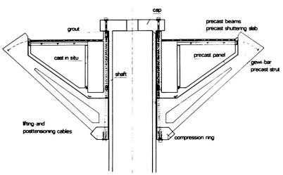
Bild 6 Schnitt durch den Hochbehälter
