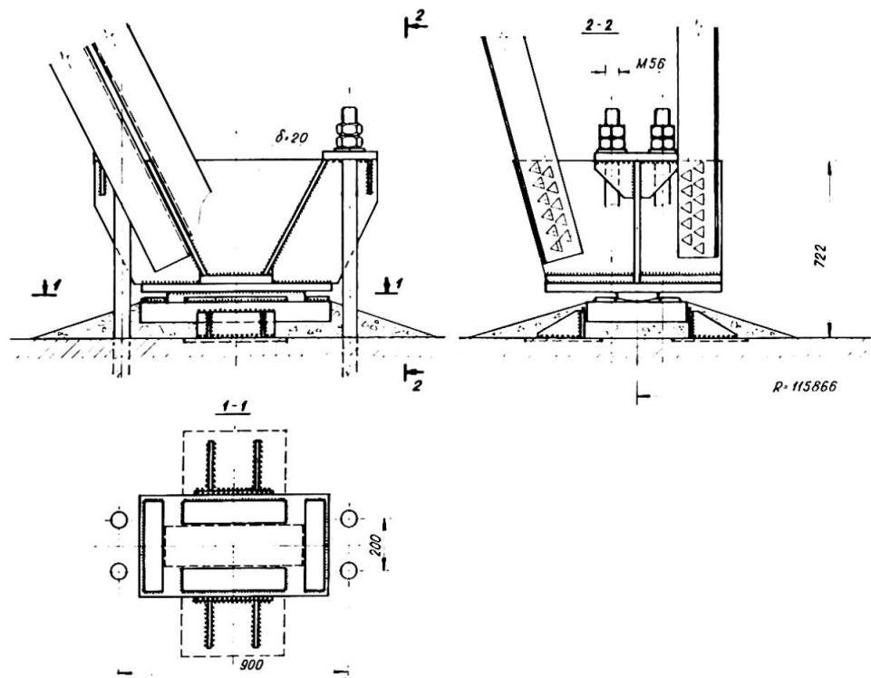
Abb. 5 Auflagerknoten des Geripps auf das Fundament
