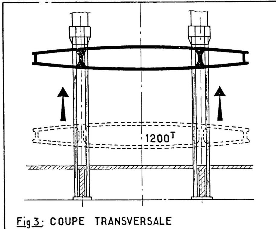
Le levage est assuré par deux batteries de 16 vérins de 200 t travaillant alternativement avec reprise des efforts d'une batterie à l'autre par l'intermédiaire de deux chevêtres mobiles brochés aux suspentes.
