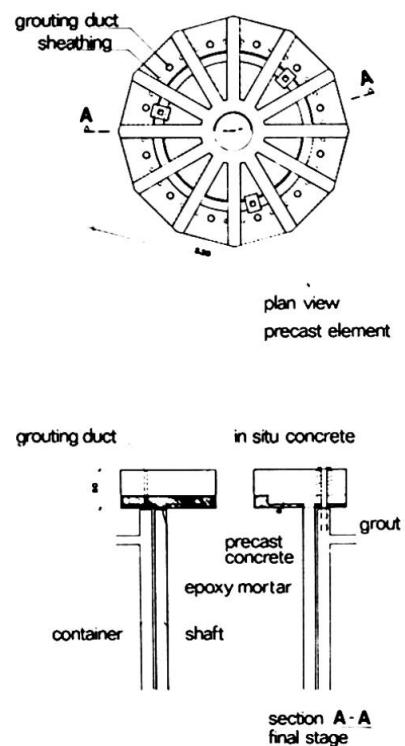
Bild 5 Teilvorgefertigte Schafkopfplatte
