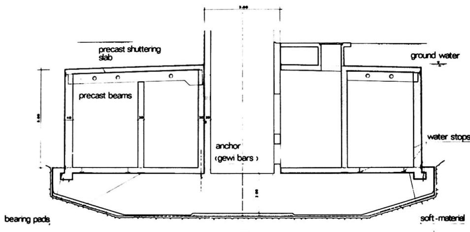
Bild 4 Schnitt durch das Turmfundament und den Bodentank
