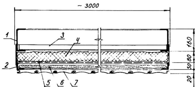
Abb. 3 Querschnitt der Hängedeckenplatte
