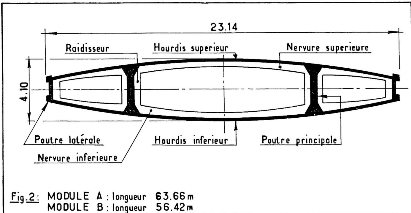
A l'extérieur des poutres principales et parallèles à celles-ci, les deux poutres latérales limitent le caisson. Leur hauteur est de 1.60 m et leur largeur de 0.20 m.
