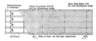
Bild 14: Doppelter Tragbelag in K**r**euzlage
