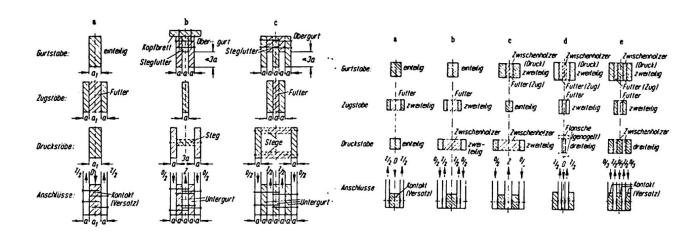
Bild 3: Mehrteilige Querschnitte ein-und mehrteiliger Stäbe für Nagelanschlüsse
