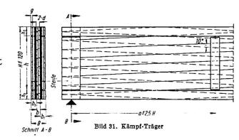
Bild 7: Kämpf-Träger (I-Träger) mit Brettersteg)
