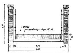
Bild 15: Brettschichtträger als Fahrbahn und als Horizontalaussteifung
