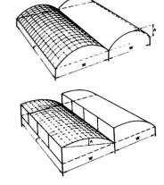
Bild 12: Kreiszylinderschalen
