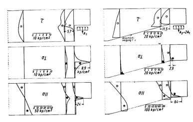
Bild 9: Spannungsverteilungen in ausgeklinkten Brettschichtträgern
