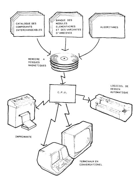
Fig. 7 Configuration du système utilisé pour le projet automatisé
