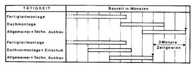
Abb. 5 Die Bauzeit bei einem Hallenbau wird dadurch verkürzt, daß die Dachkonstruktion vorgefertigt und eingeschoben wird.
