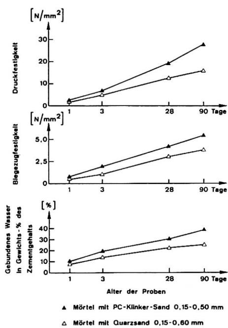
Fig. 2 Festigkeitsentwicklung mit der Zeit bei PC-Klinker-Beton und Kies-Sand-Beton
