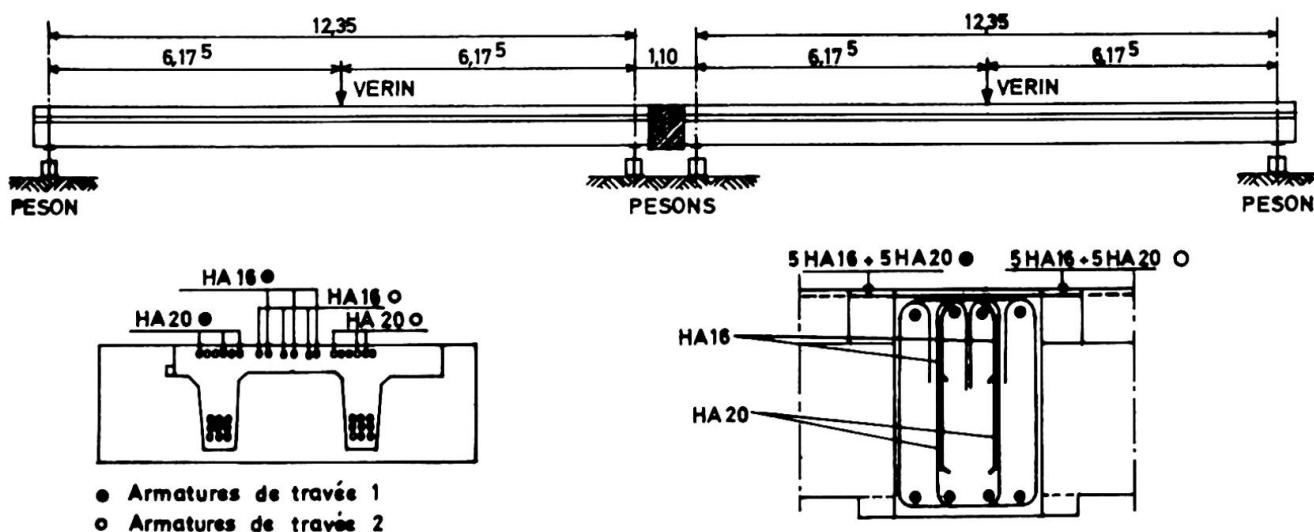
Fig. 9 - Schéma du montage soumis à essai
