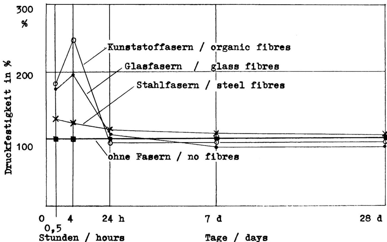
Bild 1: Erhöhung der Druckfestigkeit in jungem Alter von Beton hoher Grünstandfestigkeit durch Zugabe von 0,6 Vol-%Fasern.
