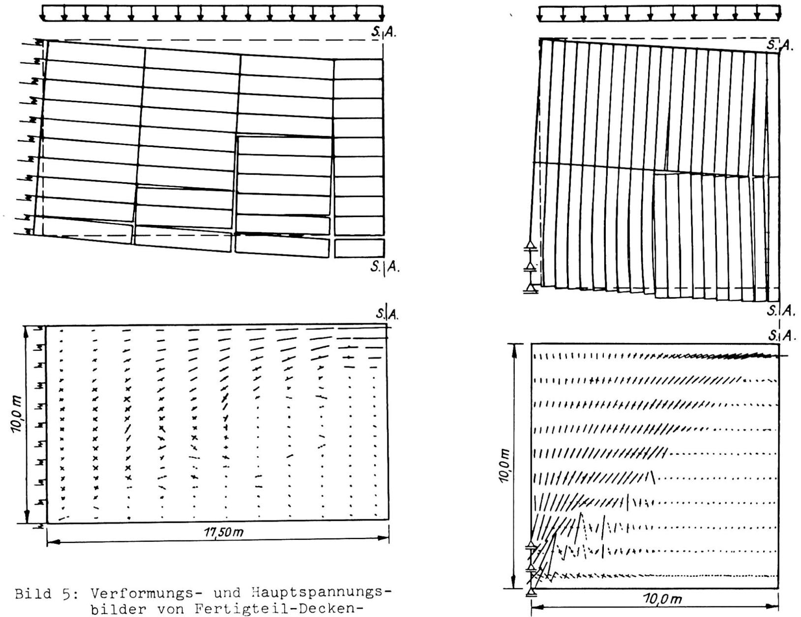
Bild 5: Verformungs- und Hauptspannungsbilder von Fertigteil-Deckenscheiben
