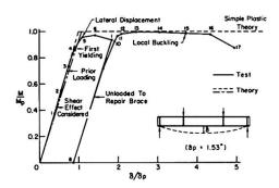
FIG. 8 BEAM UNDER UNIFORM MOMENT
