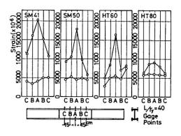
Fig. 4 Strain Distribution
