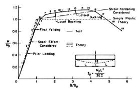
FIG. 7 BEAM UNDER MOMENT GRADIENT
