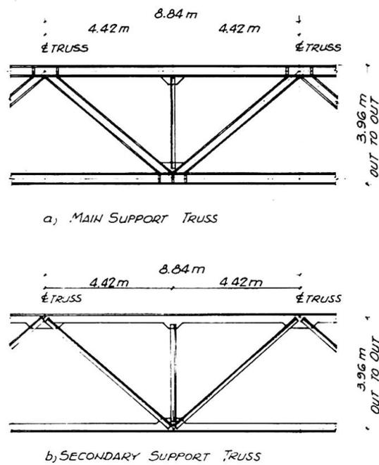
FIGURE 2. TRUSS ELEVATIONS
