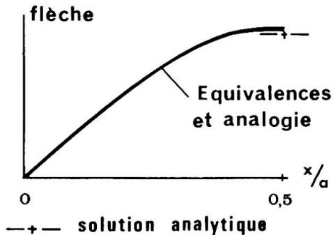
Il est remarquable d'observer que la Théorie des Equivalences et l'analogie isotherme donnent des résultats très proches bien que la première s'applique sous forme de moments aux noeuds et la seconde sous forme d'un chargement transversal.
