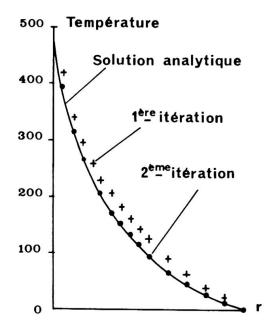
Considérons une enceinte cylindrique circulaire en béton dans laquelle nous imposons la température des deux faces  $T_i = 500^{\circ}\text{C}$ ,  $T_e = 0^{\circ}\text{C}$ . Nous supposons que la conductivité thermique du béton varie avec la température suivant la formule suivante :
