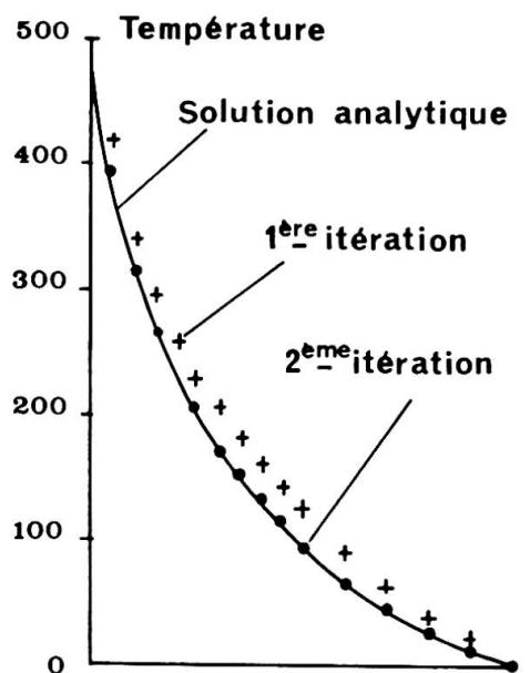
Considérons une enceinte cylindrique circulaire en béton dans laquelle nous imposons la température des deux faces  $T_i = 500^\circ\text{C}$ ,  $T_e = 0^\circ\text{C}$ . Nous supposons que la conductivité thermique du béton varie avec la température suivant la formule suivante :
