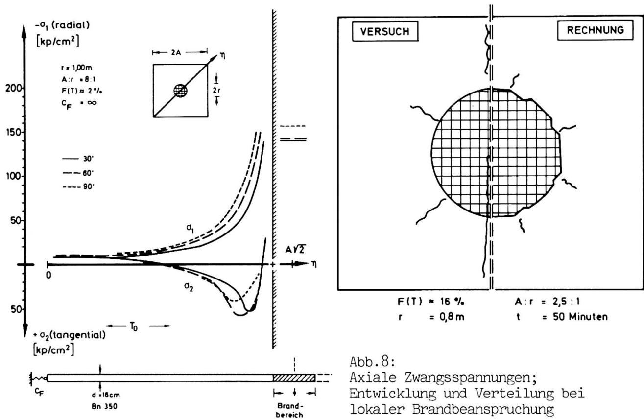
In gleicher Weise konnten zwischenzeitlich auch die von den Autoren durchgeführten ersten Versuche an planmäßig exzentrisch belasteten, brandbeanspruchten Stützen numerisch analysiert werden.
