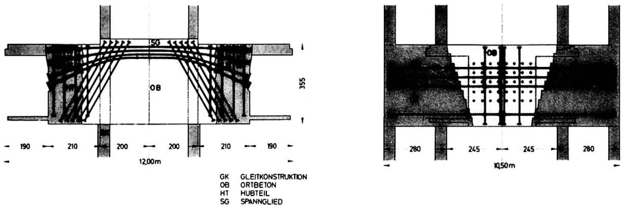
Da die relativ steifen Haupttraggeschoße empfindlich auf mögliche Setzungen reagieren, werden die äußeren Rahmenstiele nicht mit dem Fundament fest verbunden und so ausgebildet, daß ein späteres Heben oder Senken mit Hilfe hydraulischer Pressen vorgenommen werden kann.
