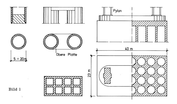
Die Caissons können bei Niedrigwasser auf Grund oder auf einer mit einer Spundwand geschützten Inselanschüttung hergestellt werden. Hat man die Gründung in schiffbarem tieferem Wasser auszuführen, so wird man heute den unteren Teil der Caissons in der Regel einschwimmen und zwischen wenigen Führungspfählen absenken oder - wie bei japanischen Brücken ausgeführt - mit großen Schwimmkranen genau am gewünschten Ort versetzen. Die japanischen
