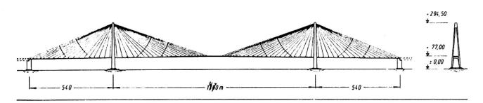
Bild 3: Entwurf Gruppo Lambertino für Brücke über die Straße von Messina, 1972
