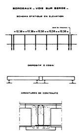
Fig. 1 Schéma statique et dispositif d'essai
