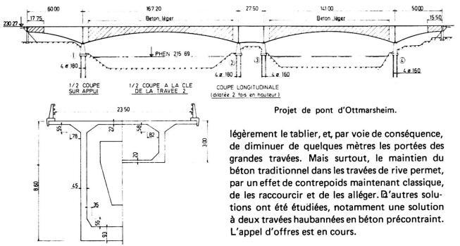
Dans les années à venir, l'emploi du béton léger devrait se développer dans le domaine de la préfabrication. En effet, l'allègement qu'il apporte permet des gains sur les moyens d'exécution, qu'il
