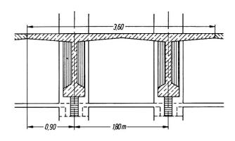
Bild 7. Querschnitt der 33,50 m langen Deckenträger in den Feldzonen
