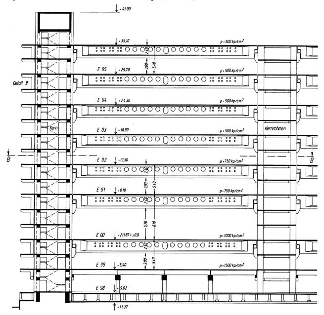
Bild 3. Querschnitt durch eine Außenfeldzone mit angrenzenden Kernzonen (Kerne) links bzw. Kernrahmen rechts. Tragsystem "Große Spannweite"
