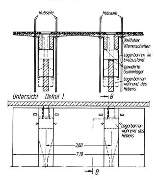
leicht demontieren zu können (Bild 6). Sie sitzen auf für diesen Fall bereits vorgesehenen Trägerkonsolen und sind mit Gewindestäben an Kernwänden und Stützen angeschraubt, um sie leicht entfernen und wieder verwenden zu können.
