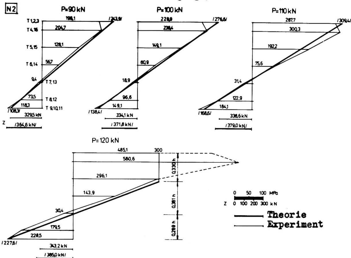
Bild 7. Träger N 2: Normalspannungen in der Mitte der Spannweite bei verschiedener Belastungsgroesse  $3 \times P$
