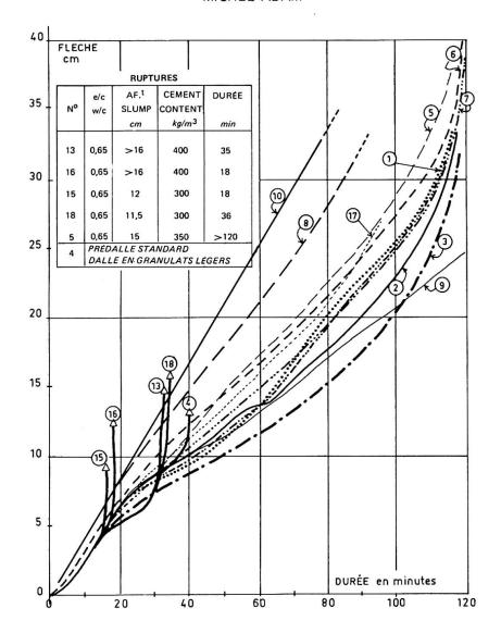
Fig. 5. Essais de prédalles (bi-couches) : Mesure des flèches.
