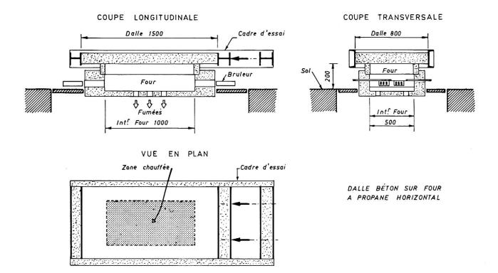
Fig. 1.- Scheme des dalles comprimées axialement et du dispositif d'essais.
