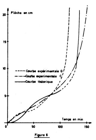
Une analyse par éléments finis a été réalisée pour la détermination de la distribution de la température (cf. [4]). On a noté une bonne concordance avec les résultats expérimentaux. La figure 6 donne l'évolution de la flèche en fonction du temps lorsque la température dans le four s'élève. Il y a deux courbes expérimentales, car deux types de béton ont été utilisés pour confectionner les poutres. On peut noter que les résultats obtenus avec notre modèle sont très satisfaisants.
