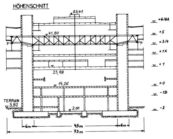
Der gesamte Außenbereich, in dem die zu den Konferenzräumen zugehörigen Nebenräume, Foyer's und Terrassen angeordnet sind, befindet sich daher nur im oberen Bereich und ist demnach auskragend. Die insgesamt sechs Betontürme im Bereich des Kreisringes übertragen alle Vertikal- und Horizontallasten nach unten. Sie sind voneinander unabhängig und haben getrennte Flachgründungen.
