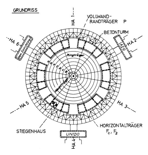
Um die Belastungen aus dem Außenbereich aufnehmen zu können, werden die Hauptträger durch entsprechende Aussparungen der Betontürme hindurchgeführt. An ihren auskragenden Enden werden alle stählernen Geschoßdecken außerhalb der Betontürme unterstützt oder aufgehängt. Die Stahldecken des inneren Bereiches werden im Kreuzungspunkt der Fachwerkträger - also im Kreismittelpunkt - unterstützt.
