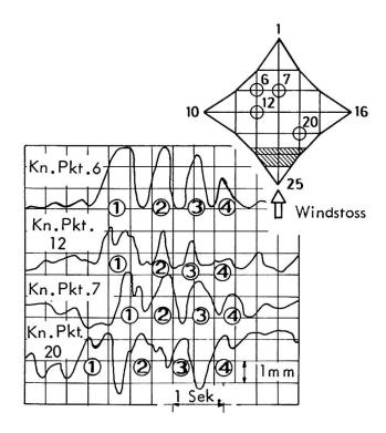
Bild 13. Response-diagramm
