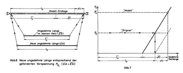
Damit jedes Seilstück von der Anfangsebene aus seine Gleichgewichtslage im Raum einnehmen kann (Abb.6), muß es um  $\Delta L$  gedehnt werden. Aus den folgenden 3 Gleichungen
