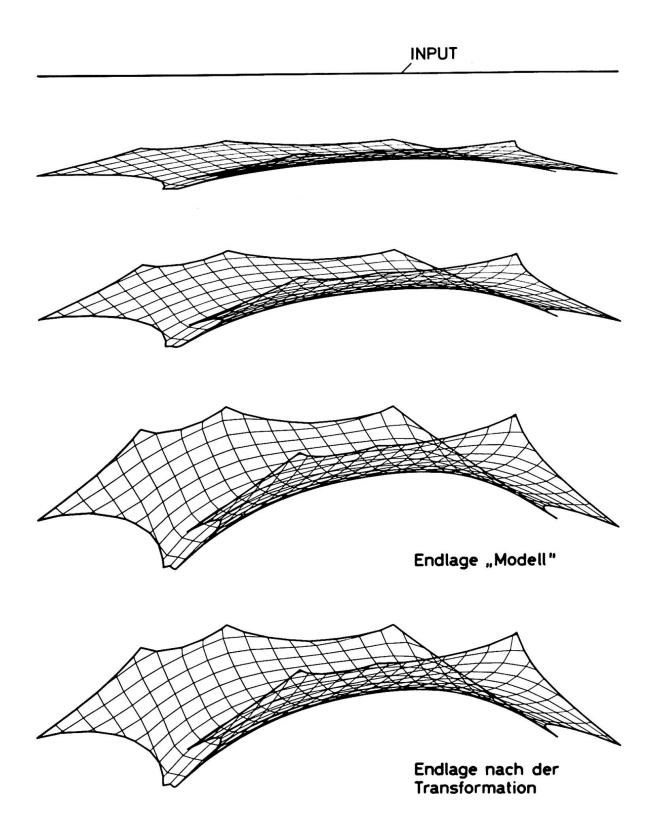
Abb.10 Hochziehen eines Netzes
