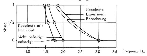
Bild 8. Erste Eigenfrequenz als Funktion der Masse
