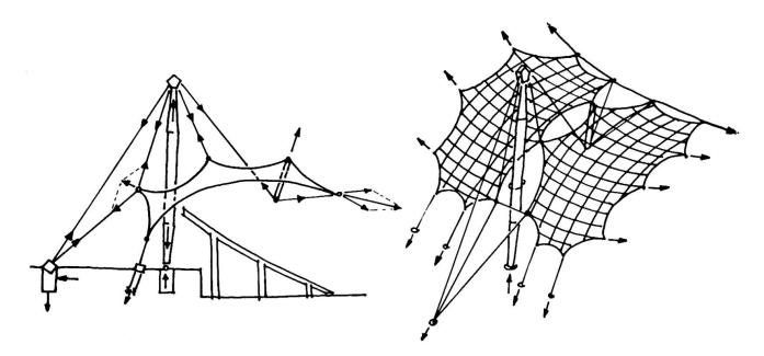
Bild 3: Das Traqwerk des Daches über der Tribüne des Stadions
