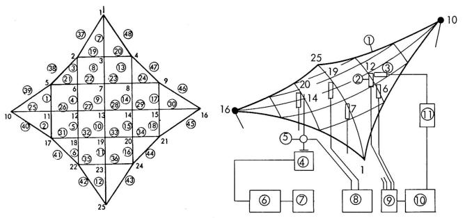
1.Kabelnetz 2.Verschiebungsmesser 3.Luftdruckmesser 4.Vibrator 5.Kraftmesser 6.Verstärker 7.Oszillator 8,10.Schreiber 9,11.Messbrücke.
