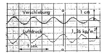
Verschiebung und Luft-Bild 10. druck in Kn.pkt. 12
