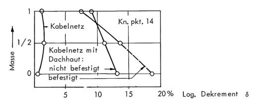
Bild 9. Dämpfung als Funktion der Masse
