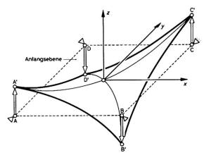
Abb.4 Umformen einer ebenen Fläche in eine vorgespannte doppelt gekrümmte Membran durch Versetzen der
