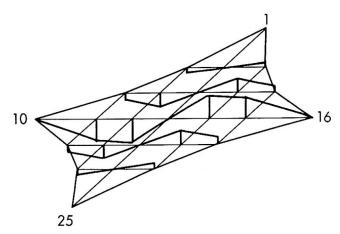
Bild 7. Erste Schwingungsform
