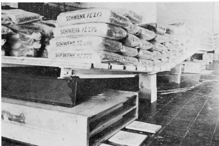
Bild 5: Versuch mit Flachspanplatten; Pfetten IPE 100 über 2 x 5,50 m gestützt; horizontales Dach ohne Zugstreben
