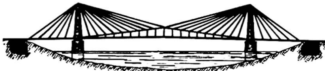
Bild 4: Schrägseilbrücke Bauart Giscard- Anodin
