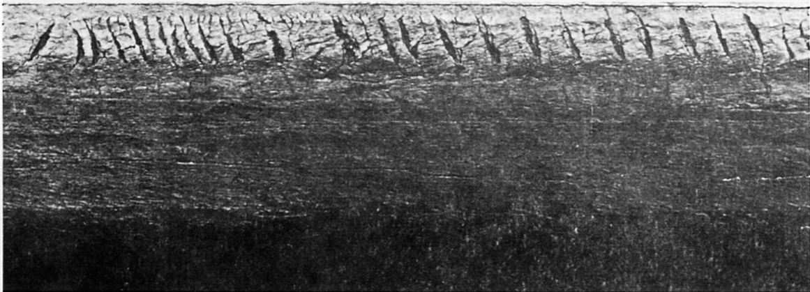
Bild 11: Verzinkter Draht mit örtlichen Aufreißungen
