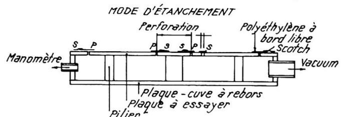
Fig.9 Section transversale de la boîte étanche.
