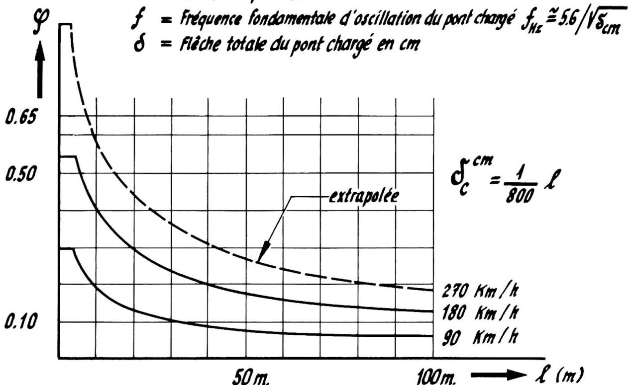
3. Les essais sur modèle ont montré que pour un véhicule donné circulant sur un pont connu dans le détail de sa superstructure, le mode oscillatoire résultant de conditions initiales identiques, se répétait dans ses moindres détails. Cela nous a autorisé à penser que l'analyse mathématique était applicable : ce qui a été fait pour le pont modèle.
