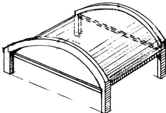
Ainsi sont nés les voiles minces en béton dont l'avantage est que le matériau de couverture forme une toiture auto-portante.
