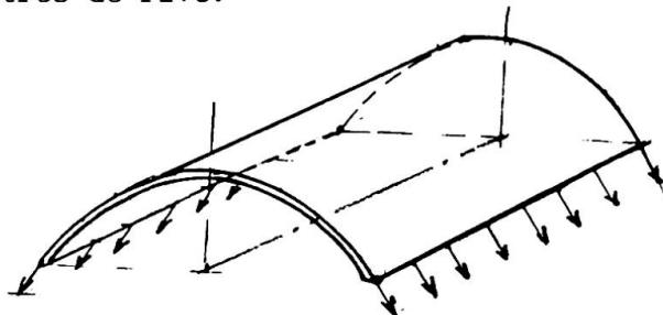
Mais finalement ces poutres de rive ont peu à peu été supprimées, les poussées de la membrane entre deux nervures au droit des poteaux ont été absorbées dans la voûte même. La membrane devient alors une coque.
