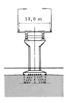
Ölandseite 124, jedes Feld etwa 35 m lang. Der Querschnitt ist ein zweistegiger Plattenbalken mit 2,66 m Höhe. Die Stege verbreitern sich am unteren Rande. Die Brückenbreite ist 13,0 m (Fahrbahn 7,0 m). Belag aus Asphaltbeton auf Mastix-Isolierung.
