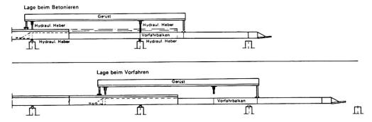
Das Vorschubgerüst aus Stahl stützt sich während des Betonierens auf hydraulischen Hebern. Mit Hilfe eines Vorfahrbalkens kann das ganze, etwa 50 m lange und 370 t schwere Gerüst weiter vorgeschoben werden. In dieser Weise wird ein Feld, d.h. eine Brückenlänge von etwa 35 m, pro Woche gebaut. Die grösste zusammenhängende Brückenlänge ist 560 m, das entspricht etwa 16 Feldern.
