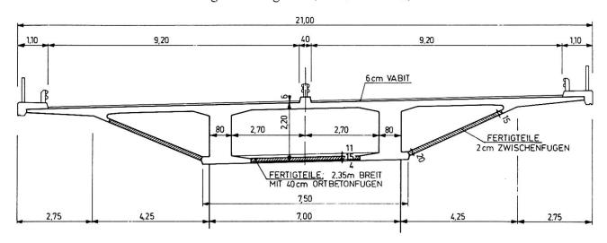
LUEGBRÜCKE SPANNBETONTRAGWERK QUERSCHNITT ABB. 2
