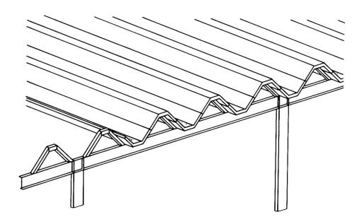
Die Gesamtheit dieser Forderungen aus Statik und Standsicherheit, Fertigung, Transport und Montage führte schließlich zu einer optimierten Geometrie von Profiltypen, mit denen sich vorerst Spannweiten zwischen 10 und 20 m überspannen lassen. Hierbei waren die m²-Kosten das entscheidende Kriterium. Die geschilderte Querschnittsoptimierung ist daher Voraussetzung für den wirtschaftlichen Einsatz dieser neuartigen Dachtragwerke in Stahl-Polyurethan-Sandwichtechnik.
