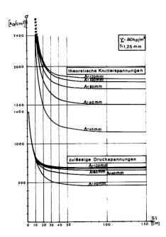
Dabei wurde bei allen errechneten Geometrien stets die Bedingung erfüllt, daß die errechneten maximalen Blechspannungen ausreichend weit unter den theoretisch ermittelten Knitterspannungen lagen. Die Sicherheit gegen Knittern bewegte sich hierbei zwischen 1,71 und 2,5.
