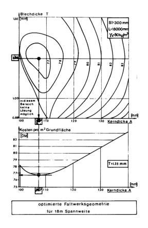
Da es fertigungstechnisch unsinnig ist, für jede Spannweite ein Faltwerk mit der jeweils kostengünstigsten Geometrie
