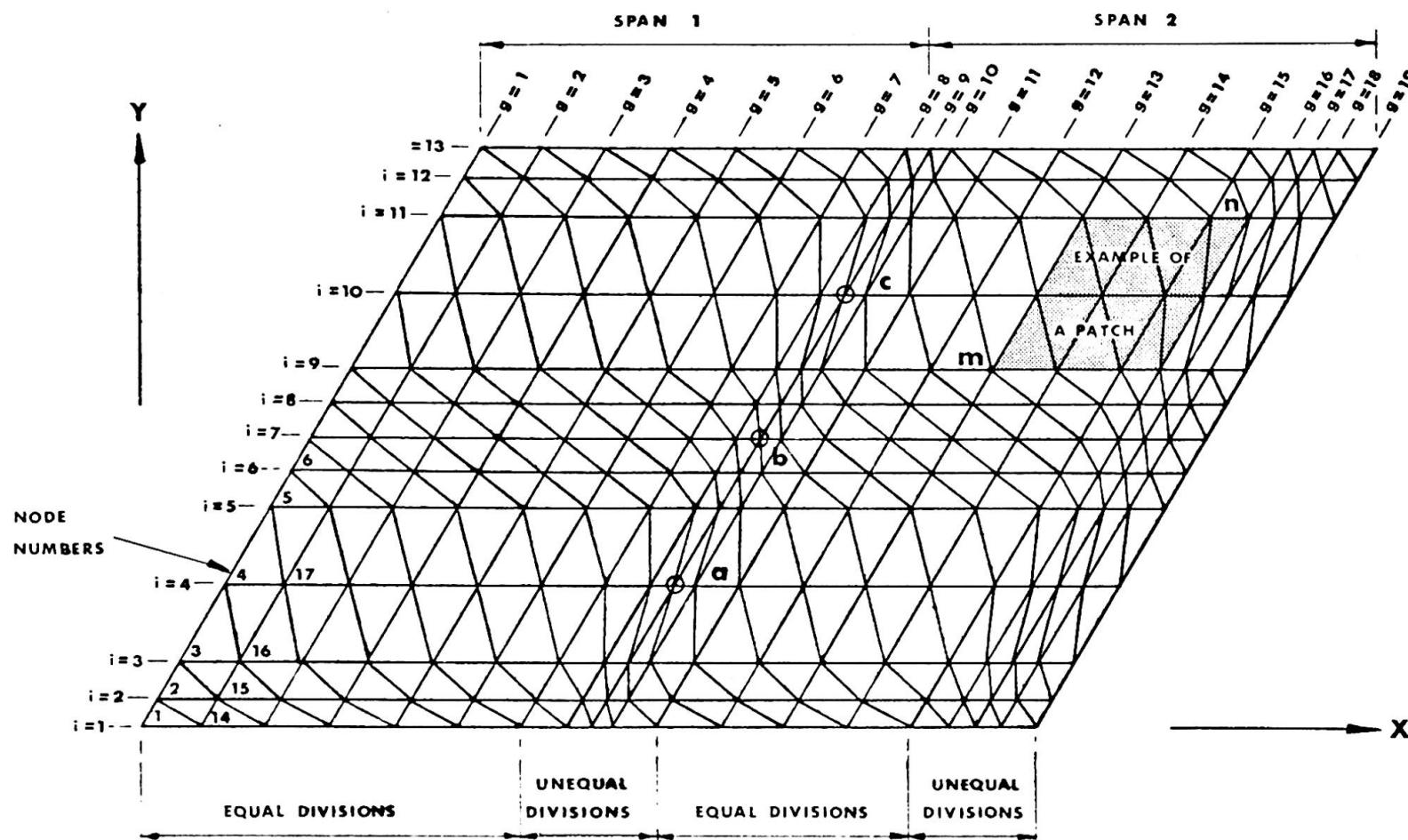
FIG 1 EXAMPLE OF DECK SPECIFICATION
