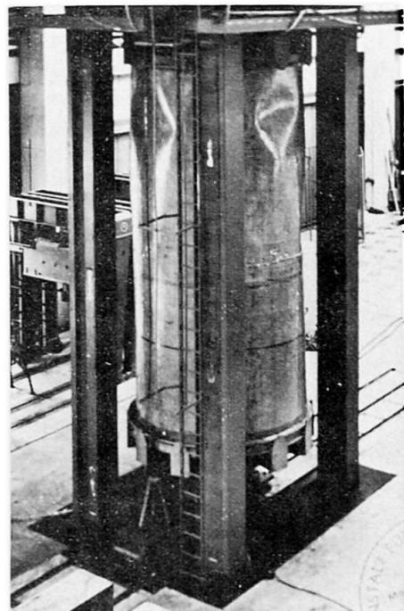
Ausgebeulter GFK-Prüfkörper  $\phi 2,45 \text{ m}, H=5,0 \text{ m}, t=5 \text{ mm}$  unter zentrischer Drucklast, Abb. 4
