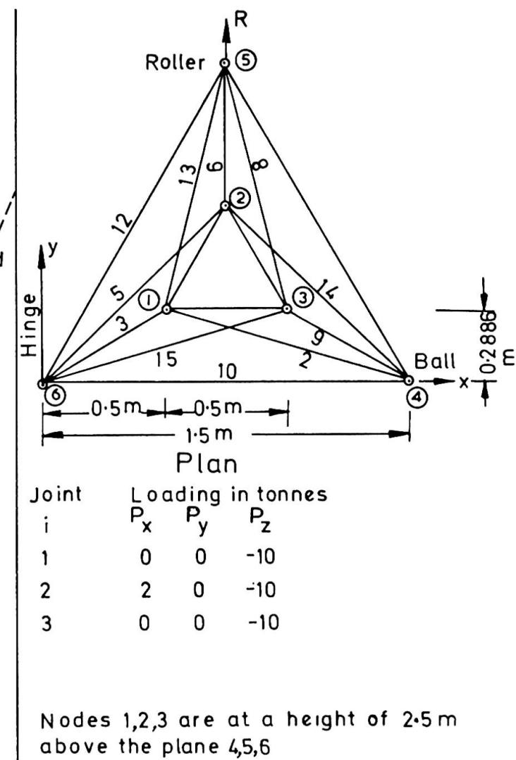
FIG.2 SPACE TRUSS-EXAMPLE-2
