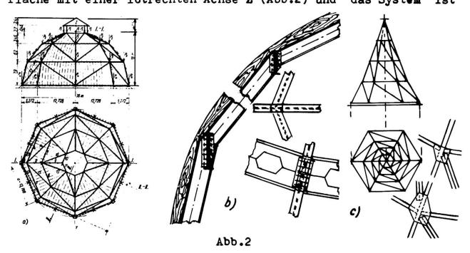
durch die in der Meridian- und Parallelenrichtung liegenden Stäbe gekennzeichnet. Dieses System ist dann das Grundsystem für viele Konstruktionen von Masten und Türmen, Gasbehältern und Kühlungstürmen, usw. (Abb. 2a, b, c). Das dreiwandige System eines Mastes nach Abb.3 weist die in gleicher Richtung laufenden Diagonalstäbe auf.
