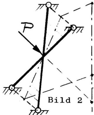
Bei rotationssymmetrischer Belastung tritt in jedem Knoten eine Last auf, die für das zugehörige Trägerkreuz (Bild 2) ebenfalls nur symmetrisch wirken kann. Bei Zerlegung dieser Last in eine Komponente in der Trägerkreuzebene und eine normal dazu erfolgt die Abtragung der ersten Lastkomponente vorwiegend durch Normalkräfte in den gekreuzten Stäben, die Aufnahme der zweiten Lastkomponente dagegen vorwiegend über Biegung des Trägerkreuzes.
