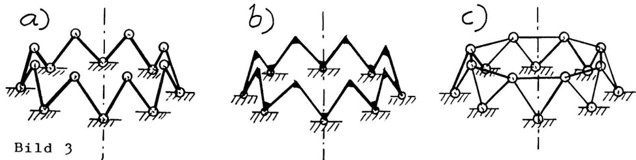
Während man das gelenkige System (Bild 3a) widerstandslos nach innen stülpen kann, leistet das System mit in den Knoten voll verbundenen Stäben (Bild 3b) Widerstand gegen eine solche Verformung, und zwar durch die mobilisierte Biege- und Torsionssteifigkeit der Stäbe. Dasselbe gilt auch für das Gesamtsystem nach Bild 1a. Die biege- und drehsteife Verbindung der Stäbe führt daher zu einer Reduktion der Biegemomente auf Kosten von Torsionsmomenten.
