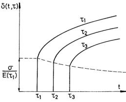
Dans ce cas, les parties courbes de la figure 2 sont semblables de forme. Si la contrainte varie suivant la loi connue  $\sigma = \sigma$   $(\tau)$ , on admet avec Boltzmann que la dilatation totale  $\bar{\epsilon}$  est donnée à un instant t quelconque par la formule
