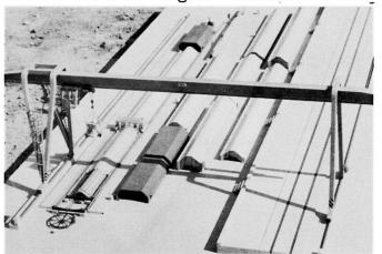
Bild 6 Modellaufnahme einer Fertigungsstätte für VT-Falten
