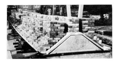
Bild 4 Testversuch (Ziegelbelastung)
