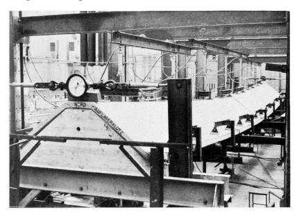
Bild 9 Tragfähigkeitsversuch VT-Falte 18
