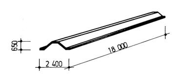
Bild 1 VT-Falte 18 Standardelement
