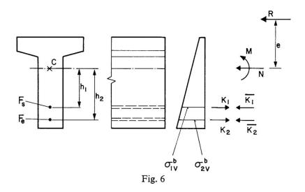
wobei  $\sigma_{11}$  = Betonspannung in Höhe 1 infolge  $K_1$  und die Koeffizienten  $\sigma_{12}$ ,  $\sigma_{21}$  und  $\sigma_{22}$  entsprechend definiert sind. Sofort nach dem Spannen oder wenn die Spannungsumlagerungen infolge Kriechens und Schwindens vernachlässigt werden, beträgt die Kraft  $K_2$  null.
