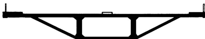
Fig. 43. Brücken-Querschnitt mit seitlichen dreieckigen Hohlkästen.
