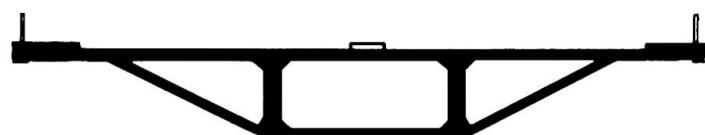
Fig. 43. Brücken-Querschnitt mit seitlichen dreieckigen Hohlkästen.
