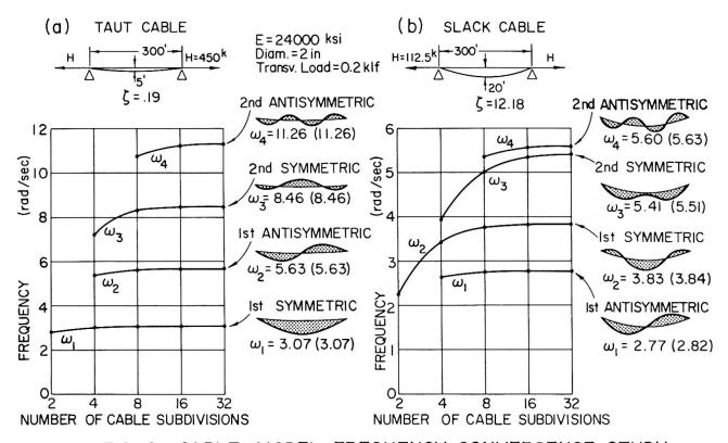
FIG. 2 CABLE MODEL FREQUENCY CONVERGENCE STUDY
