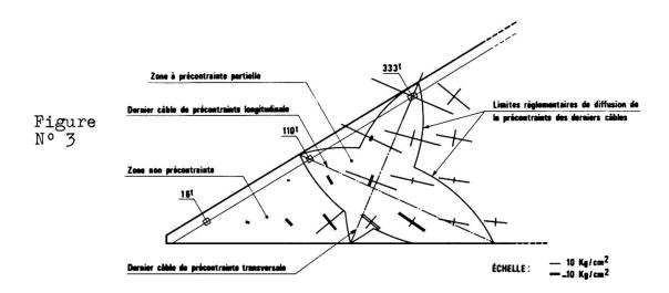
Dans cet exemple le premier dessin montre la distribution des moments fléchissants sous une charge uniforme. Le second dessin montre les contraintes suivant la face inférieure au voisinage de l'angle aigu. D'autres zones de précontrainte partielle existent, en particulier au-dessus des points d'appui des angles obtus.
