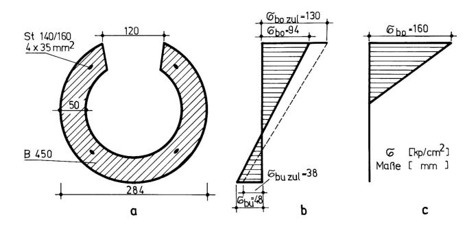
Bild 5: a) Für die Bemessung maßgebender Querschnitte des Leuchtenmastes L 10.0
