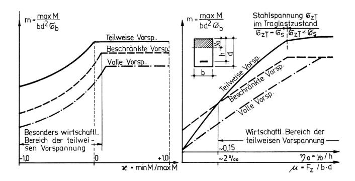
Bild 1:Tragvermögen von Spannbetonquerschnitten unterschiedlichen Vorspanngrades in Abhängigkeit vom Belastungsverhältnis
