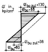
Bild 4: Betonspannungen nach Zustand I für den Belastungszustand v+mαxφ+q und die nach [1] für beschränkte Vorspannung zulässigen Spannungen
