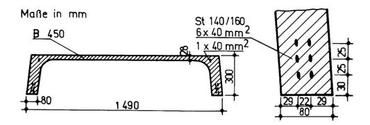
Bild 3: Querschnitt der 12 m-Dachkassettenplatte
