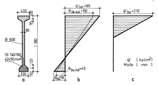
Bild 6: a) Querschnitt im Drittelspunkt eines Vollwandbinders für 24 m Spannweite
