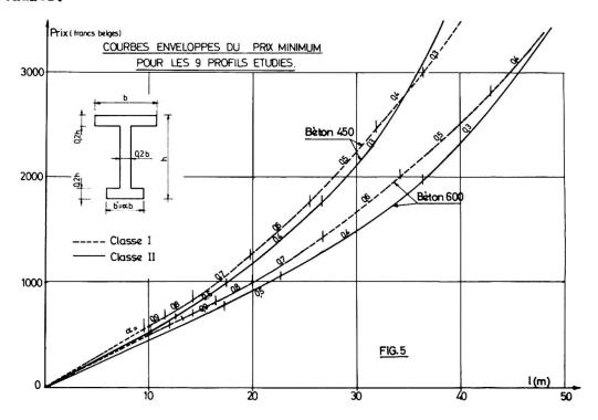
On constate d'après ces courbes que la classe II permet de réaliser une économie sensible en-deça d'une portée limite de 63 mètres dans le cas du béton B. 600 et de 35 mètres dans le cas du béton B. 450.
