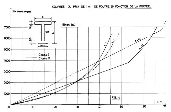
9 profils étudiés, les courbes donnant l'évolution en fonction de la portée, du prix par mètre courant de poutre, respectivement en classe I et en classe II, pour deux qualités de béton (B. 450 et B. 600).
