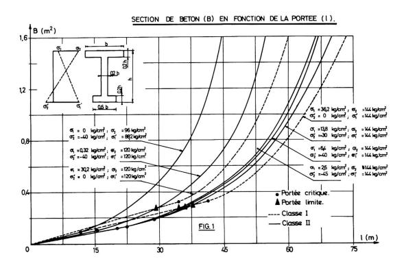
La figure 1 montre l'évolution de l'aire B en fonction de la portée. Les courbes en traits interrompus sont relatives aux poutres précontraintes tandis que les courbes en traits pleins correspondent aux poutres partiellement précontraintes.
