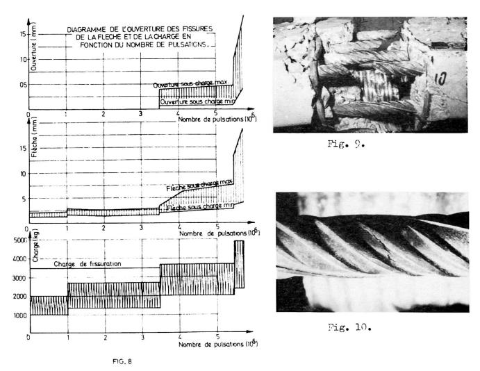
très fréquents où les armatures passives se rompent prématurément en fatigue sous l'effet des sollicitations alternées auxquelles elles sont soumises.
