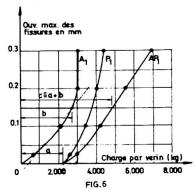
In figure 6 donne, à titre d'exemple, l'évolution comparée de l'ouverture maximale des fissures en fonction de la charge appliquée, pour une poutre AP et pour les poutres  $\Lambda$  et P correspondantes.
