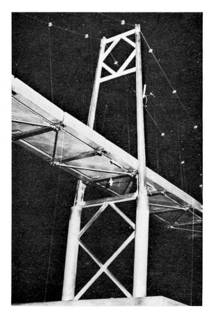
à l'échelle choisie, et le tablier a été remplacé par des crochets d'acier qui les relient sur des diagonales consécutives. Les poutres transversales sont pourvues de dispositifs d'amarrage étudiés en vue d'assurer, sous la face in férieure, l'attache des câbles de rigidité et, sur la face supérieure, celle des tirants obliques de suspension.
