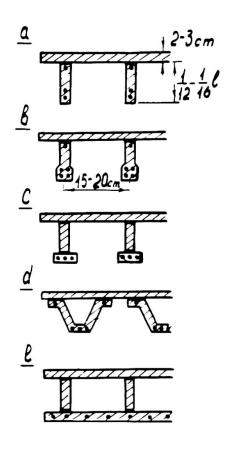
Les nervures doivent avoir une armature prétendue du côté inférieur
