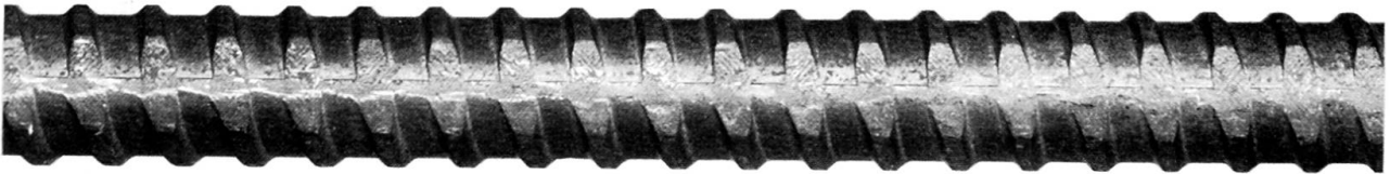
Bild 1: Dywidag-Gewindestab \varnothing 26 mm mit beidseitig aufgewalzten Rippen
