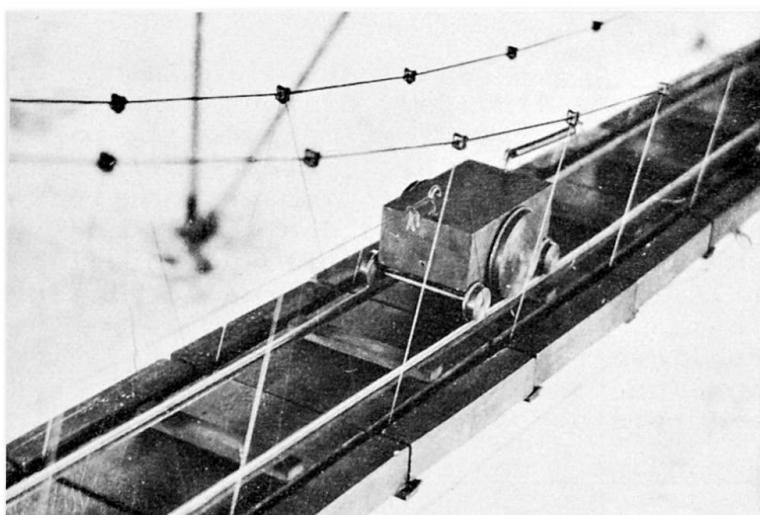
qu'ils représentent agisse sur le modèle, dans les mêmes conditions que le poids réel agira sur la structure du prototype. On les a également dimensionné de façon qu'ils aient tous la même hauteur.
