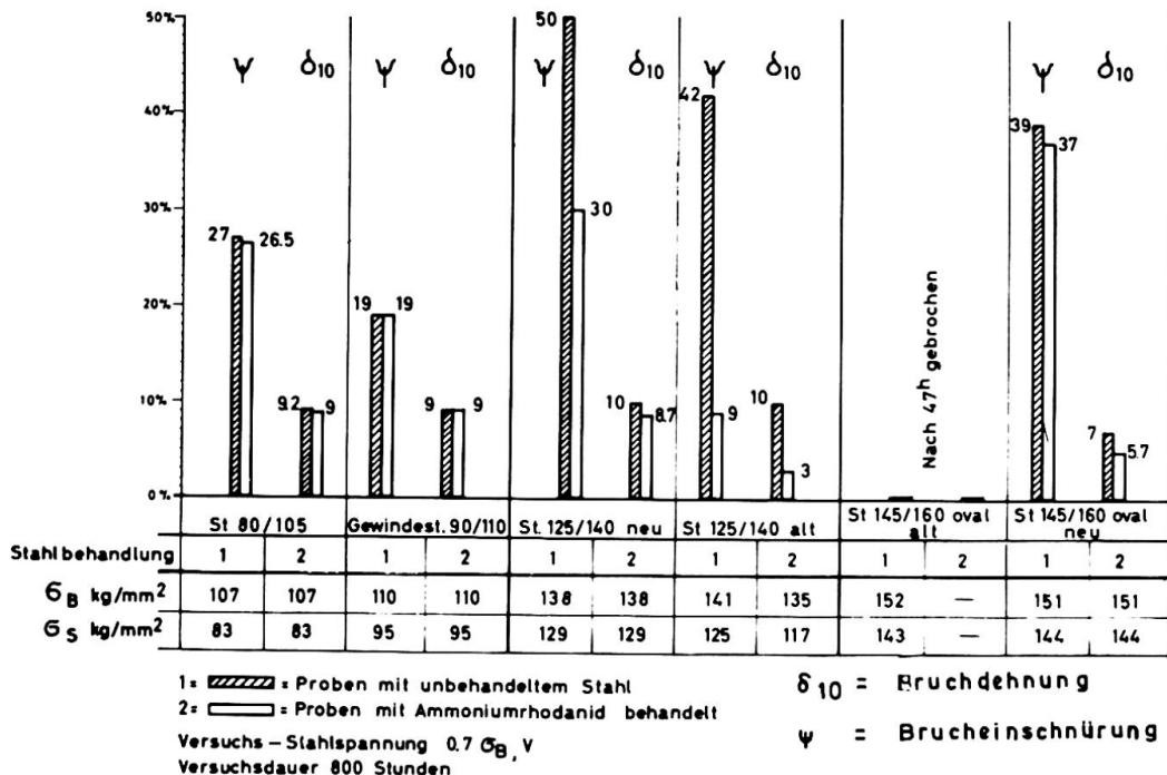
Bild 5: Ergebnisse der Spannungsrißkorrosions - Vergleichsversuche
