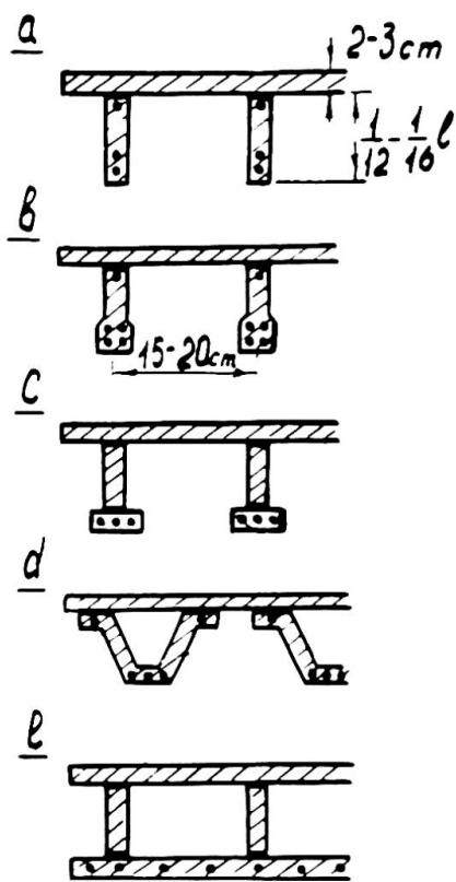
Les nervures doivent avoir une armature prétenue du côté inférieur
