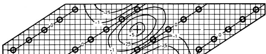
Fig. 7 Surface d'influence de la déformation au centre.
