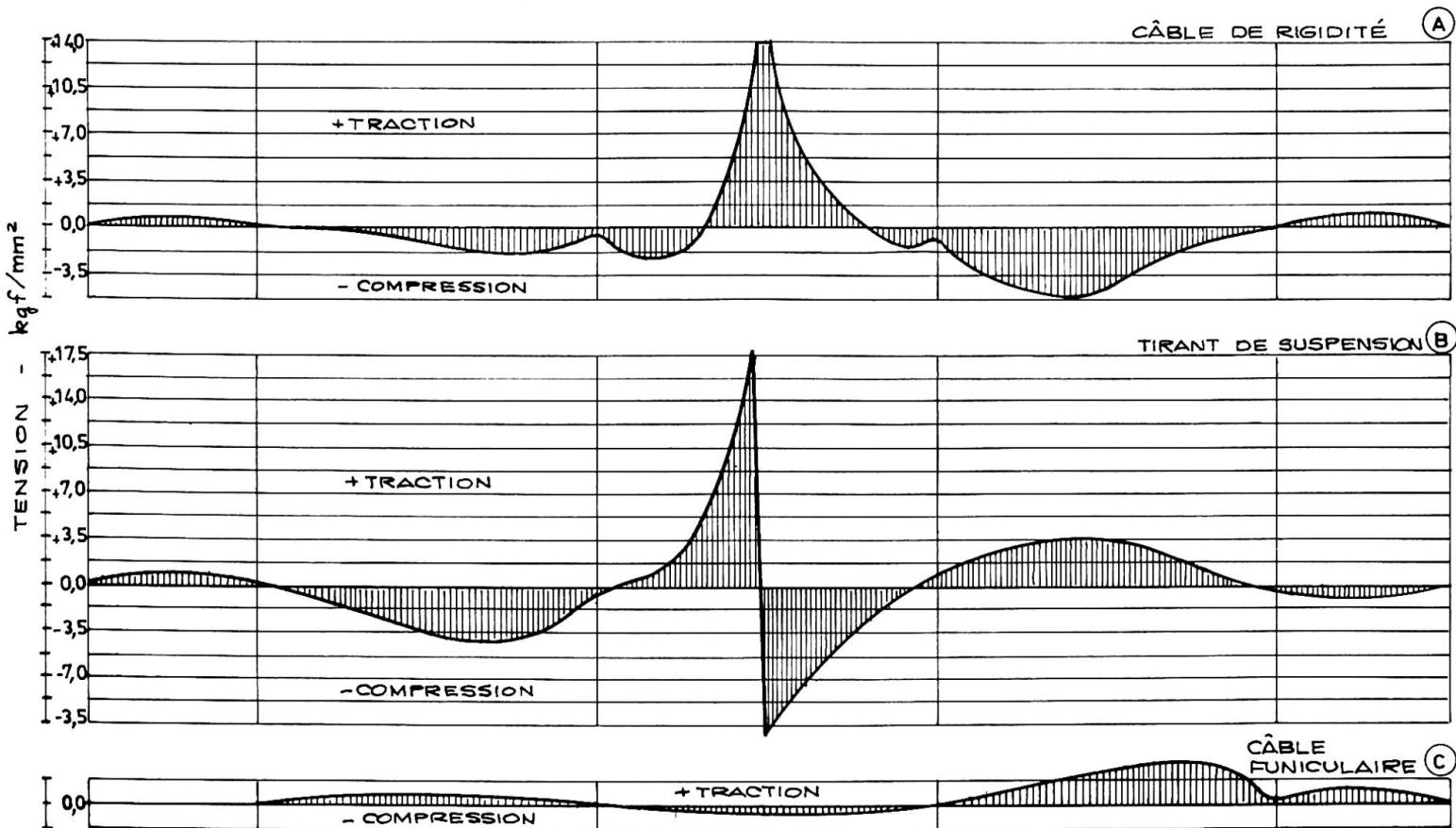
Ainsi peut-on conclure que les câbles funiculaires, les tirants de suspension et les câbles de rigidité, dans leur fonctionnement d'ensemble, font que les impulsions sur le couronnement des tours se réduisent à des valeurs inférieures au dixième des valeurs des déplacements correspondant à l'action isolée des câbles funiculaires (d'environ 85 kilos, pour environ 7 kilos).
