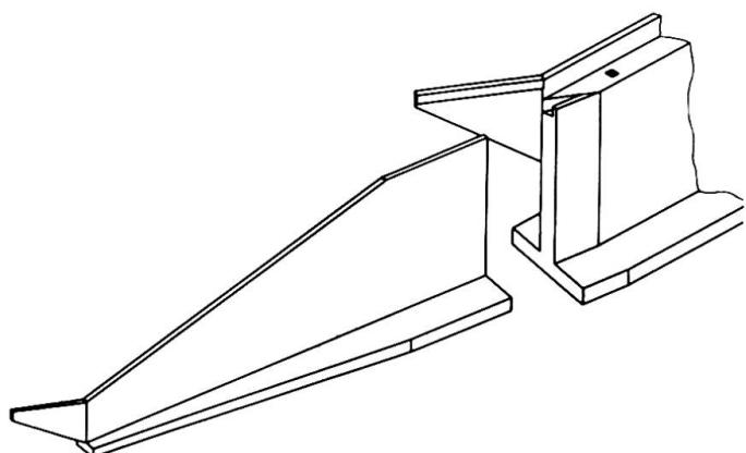
Fig. 17b Vue en projection cylindrique du mur en retour amont.
