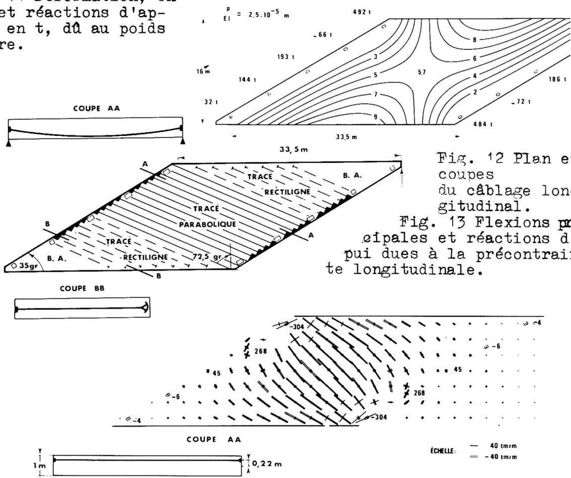
Fig. 12 Plan et coupes du câblage longitudinal.
