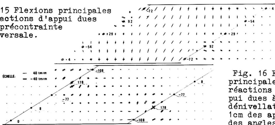
Fig. 16 Flexions principales et réactions d'appui dues à une dénivellation de 1cm des appuis des angles obtus.
