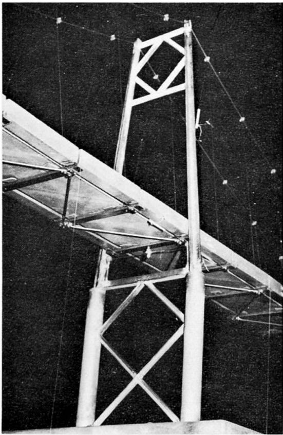
à l'échelle choisie, et le tablier a été remplacé par des crochets d'acier qui les relient sur des diagonales consécutives. Les poutres transversales sont pourvues de dispositifs d'amarrage étudiés en vue d'assurer, sous la face inférieure, l'attache des câbles de rigidité et, sur la face supérieure, celle des tirants obliques de suspension.
