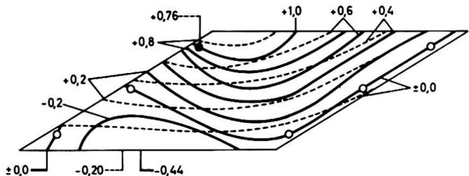
Fig. 6 Surfaces d'influence de la réaction de l'appui de l'angle obtus, les appuis étant rigides (trait plein) et élastiques (trait pointillé).
