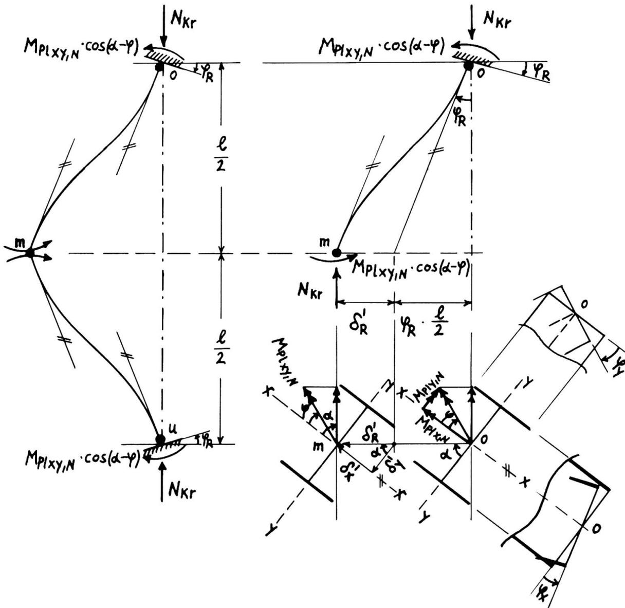
Bild 2.4 : Kräftespiel und Verformungen beim Erreichen der Traglast (Kopf- und Fussdrehwinkel gleich gross)
