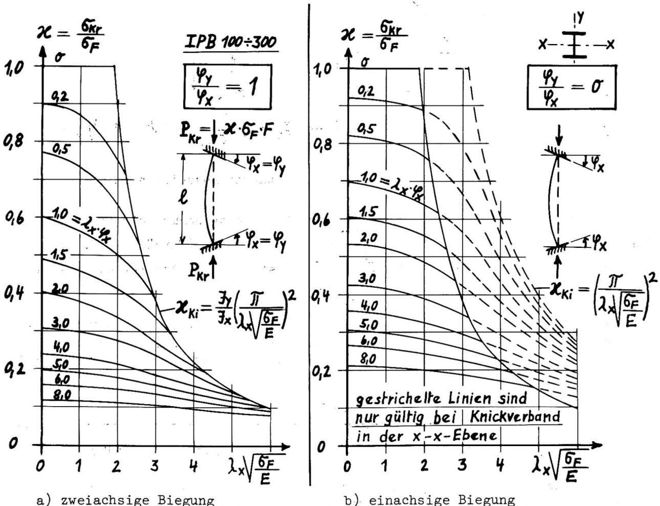
Bild 2.6 : Traglasten eingespannter Stützen mit Kopf- und Fussverdrehung
