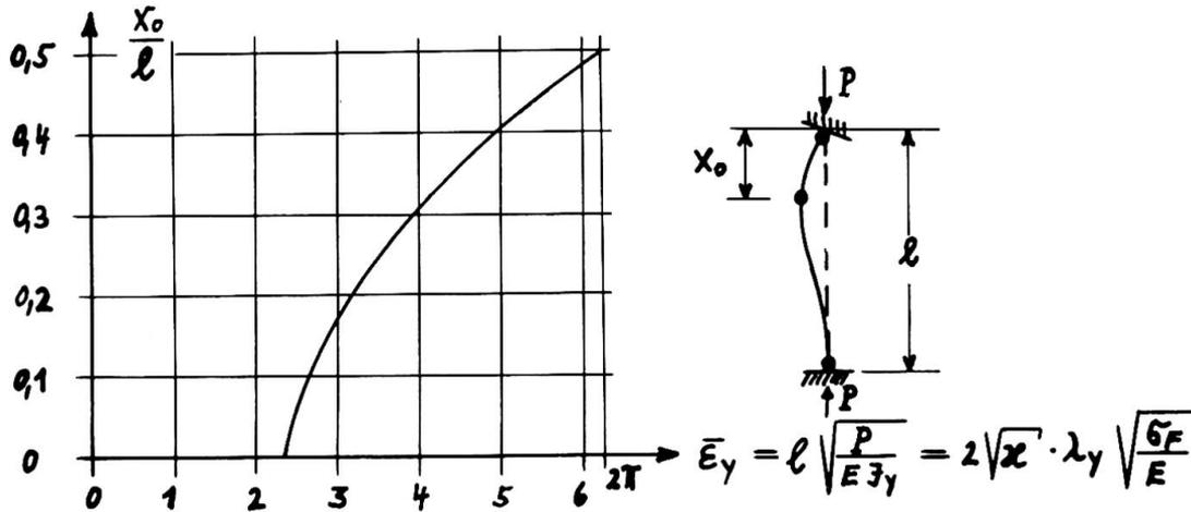
Bild 2.7 : Lage des 1. Fließsgelenks bei starrer Füsseinspannung
