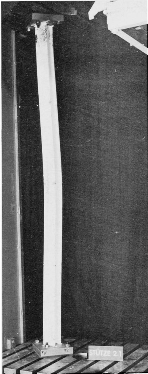
Bild 3.1 : Stütze 2.1 nach dem Traglastversuch
