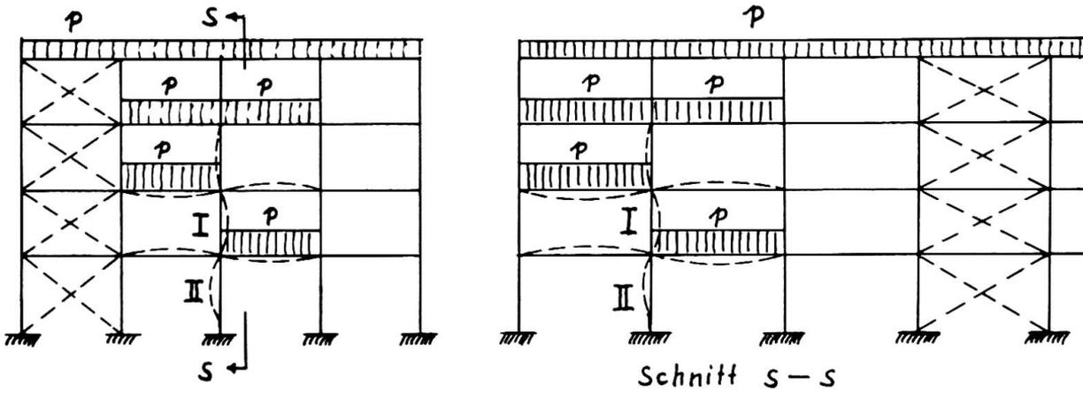
Bild 2.3 : Schachbrettbelastung im Bereich der untersuchten Stützen
