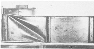
FIGURE 10 - GIRDER TG5 AFTER TEST TO FAILURE
