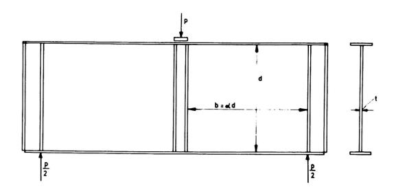
FIGURE 8 - DETAILS OF TEST GIRDERS
