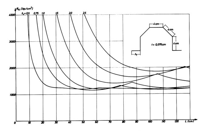
Bild 3 Beulknickspannungen symmetrich für Hut-Profil (Gabellagerung)
