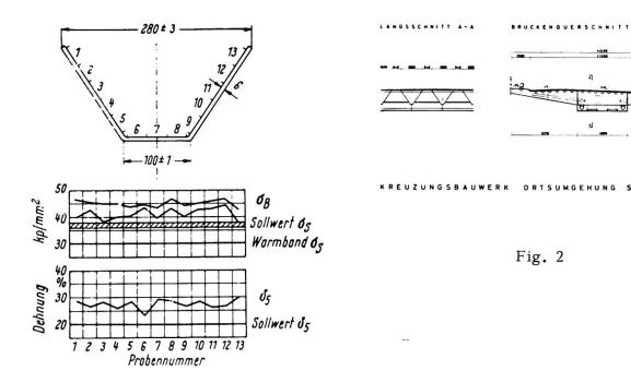
Fig. 1 Mechanische Werte eines Trapezprofils St 37-3 m.e.S.
