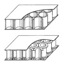
Bild 19: Isotrope Stahlkern-Sandwichplatten
