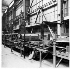
Bild 14: Stahl/PU-Sand-wichkontilinie
