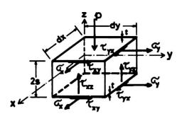
Im Falle dünner Deckschichten mit leichtem Kern, wenn also ein Membranspannungszustand der Deckschichten angenommen werden kann, wird die gesamte Querkraft vom Kern aufgenommen (Bild 4). Für die Lösung dieses baupraktisch wichtigen Falles eignet sich gut das Ritz'sche Verfahren, das sich auf das Prinzip vom Minimum der potentiellen Energie stützt. Dieses kann formuliert werden in dem Ausdruck:
