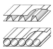
Bild 20: Orthotrope Stahlkern-Sandwichplatten
