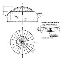
Bild 18: Sandwich-Kugel-
