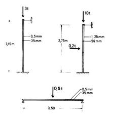
Bild 8: Sandwichtraglastversuche
