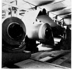
Bild 13: Stahl/PU-Sand-wichkontilinie
